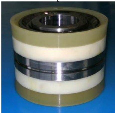
Рисунок 16 – Модель поршня бурового насоса
