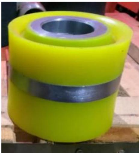
Рисунок 17- Полиуретановый поршень
